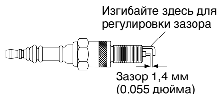
Рис. 12. Регулировка зазора свечи зажигания, нагреватель мощностью 10 кВт
