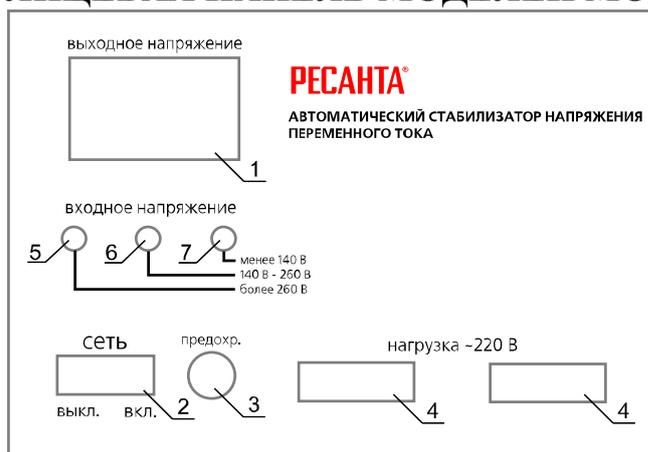
1. Вольтметр (для измерения выходного напряжения)
