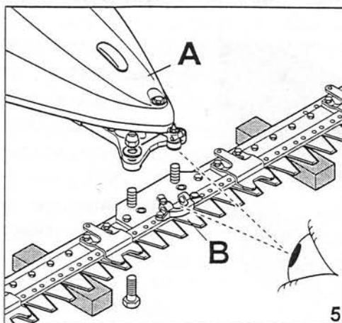
Проверьте, чтобы водило как следует сидело в гнезде, затем смонтируйте косилку **B** и панель **A** двумя гайками (рис. 5).
